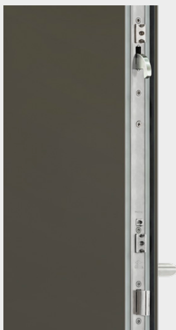
INGRESSO CONDOMINIALE Multitop Matic con Motore CISA Serratura multipunto con chiusura automatica, apertura motorizzata da remoto e segnale di stato porta.
